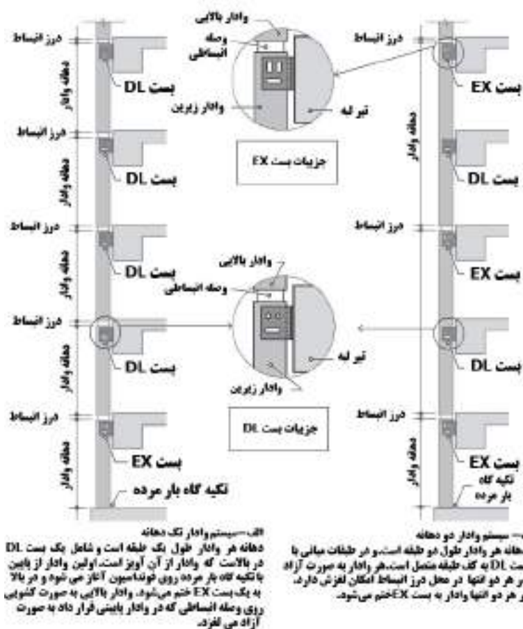
شکل ۹-۸- سیستم‌های تکیه‌گاهی برای دیوارهای پرده‌ای شیشه با وادار تک و دو دهانه
