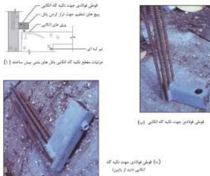
شکل ۱۰-۵- پروفیل قوطی شکل به عنوان تکیه گاه اتکایی و پیچ تنظیم ارتفاع
