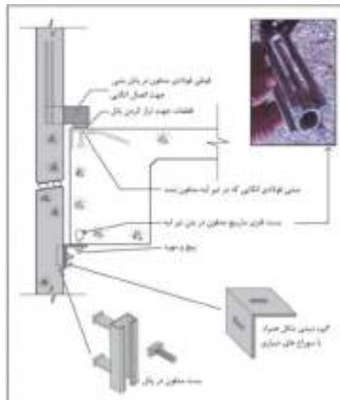
ب- نمونه اجرای اتصال لوبیایی به تیر در پانل بتنی پیش ساخته
