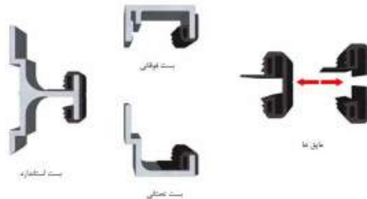
شکل ۷-۵- نصب درزپوش بر روی مهارها
