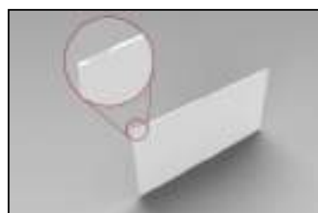
۵- شیار زدن ضخامت سرامیک‌ها
