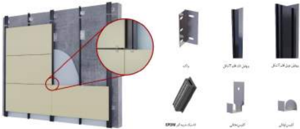
شکل ۷-۹- اجزای سیستم نصب نمایان
