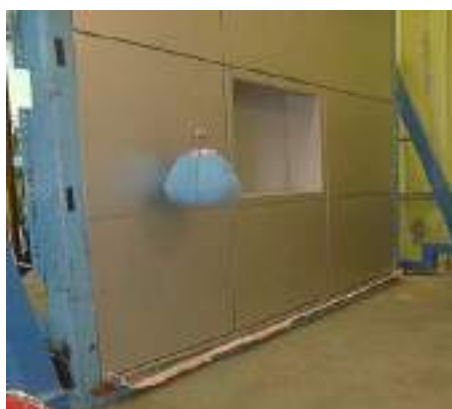
شکل ۳-۵- آزمایش ضربه جسم نرم سنگین روی نما
