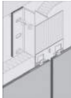
الف- نمونه اجرای اتصال لوبیایی به تیر در اجرای خشک نمای سرامیکی
