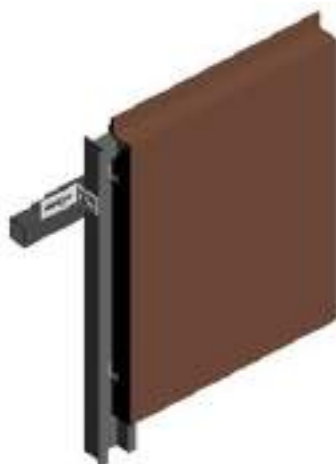
شکل ۸-۴- نمونه‌ای از روش اجرای هوک
