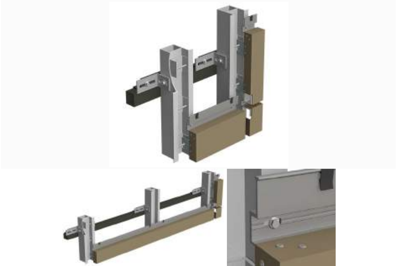
شکل ۸-۵- نمونه‌ای از روش اجرای ثابت-ریلی
