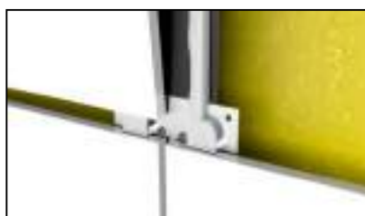
۶- قرار دادن کلیپس فوقانی و نصب سرامیک
