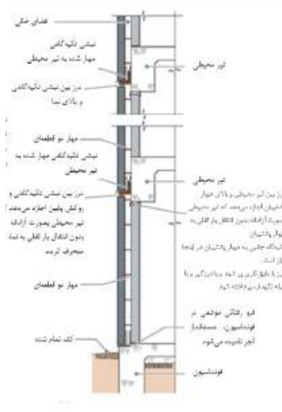
شکل ۵-۸- تکیه گاه ها جهت تحمل بار ثقلی نما
